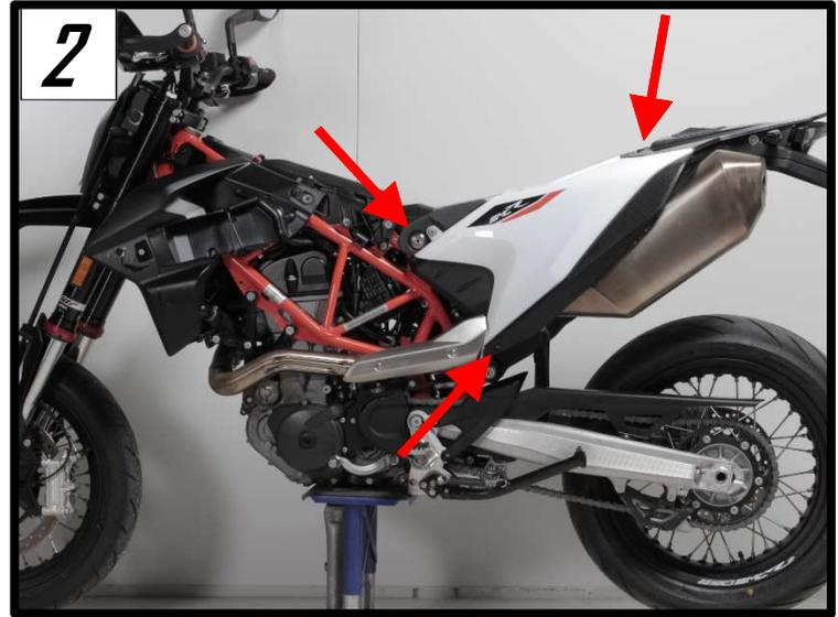
Lösen Sie die Halterschraube und die Schelle des Serienschalldämpfers und nehmen diesen ab (Abb. 3 / 4).
